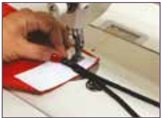
Fixation renforcée de la cordelette
